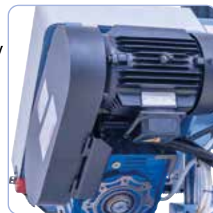
Napęd pasowy z 3 regulowanymi prędkościami cięcia.
