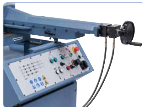
Przesuwne imadło, zacisk ręczny lub hydrauliczny.
