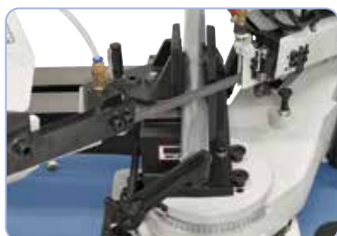
Wychylnie ramię piły do cięć pod kątem od -45^\circ do +45^\circ .
