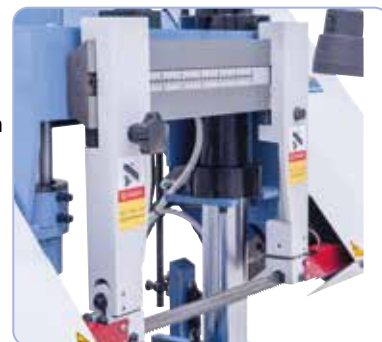
Regulowana prowadnica piły zapobiega jej przesuwaniu się na boki lub wychyleniu z pionu.
