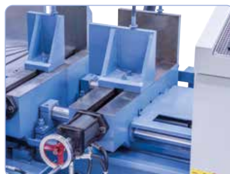
Posuw materiału poprzez hydrauliczny zacisk i precyzyjne prowadzenie cylindryczne
