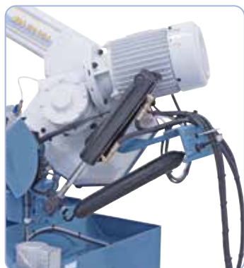
W wyposażeniu standardowym z hydraulicznym siłownikiem do bezstopniowego opuszczania ramienia piły i automatycznym wyłączeniem po zakończeniu cięcia materiału.
