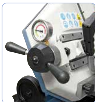
W wyposażeniu standardowym manometr do optymalnej regulacji naciągu piły taśmowej.
