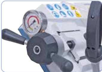
Optymalna regulacja naciągu piły taśmowej za pomocą manometru.
