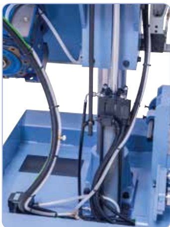
Ramię pily precyzyjnie opuszcza się za pomocą siłownika hydraulicznego.
