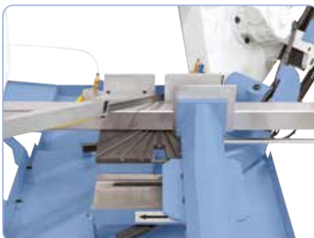
Imadło z szybkim ryglowaniem przesuwne do podwójnych cięć pod skosem.
