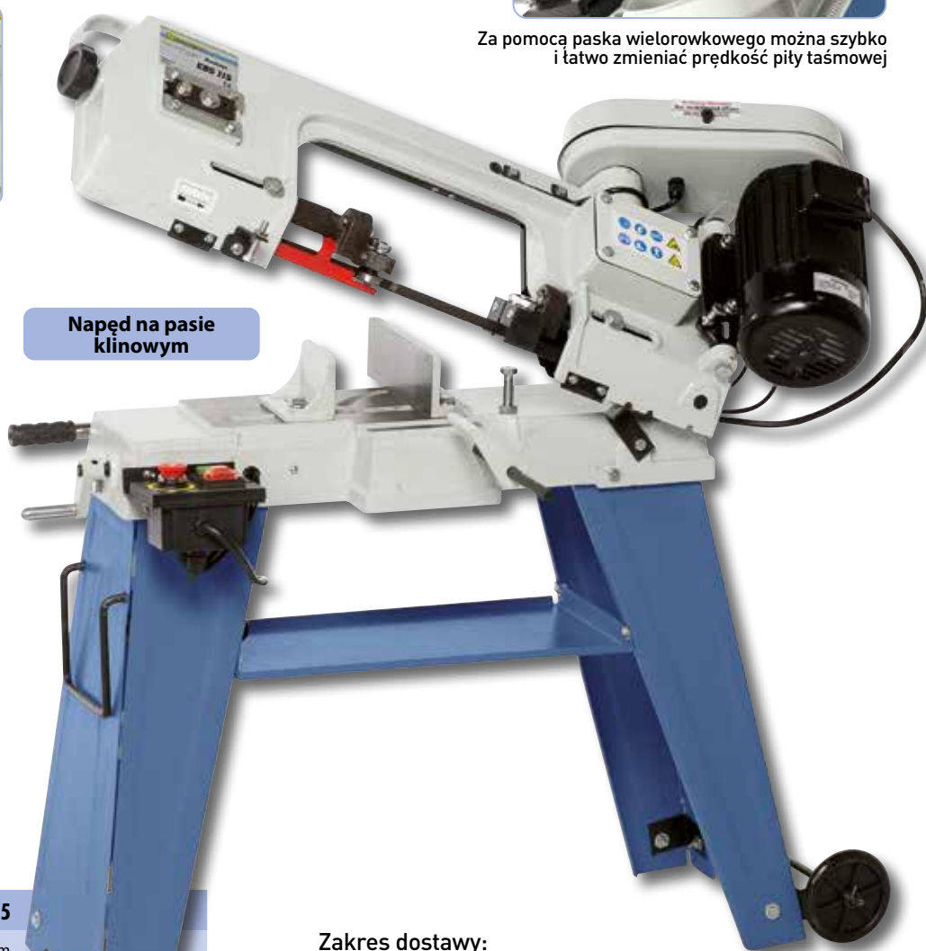
Wyłącznik bezpieczeństwa z wyzwalaczem podnapięciowym i oddzielnym przyciskiem zatrzymania awaryjnego, automatyczne wyłączenie piły po zakończeniu cięcia
