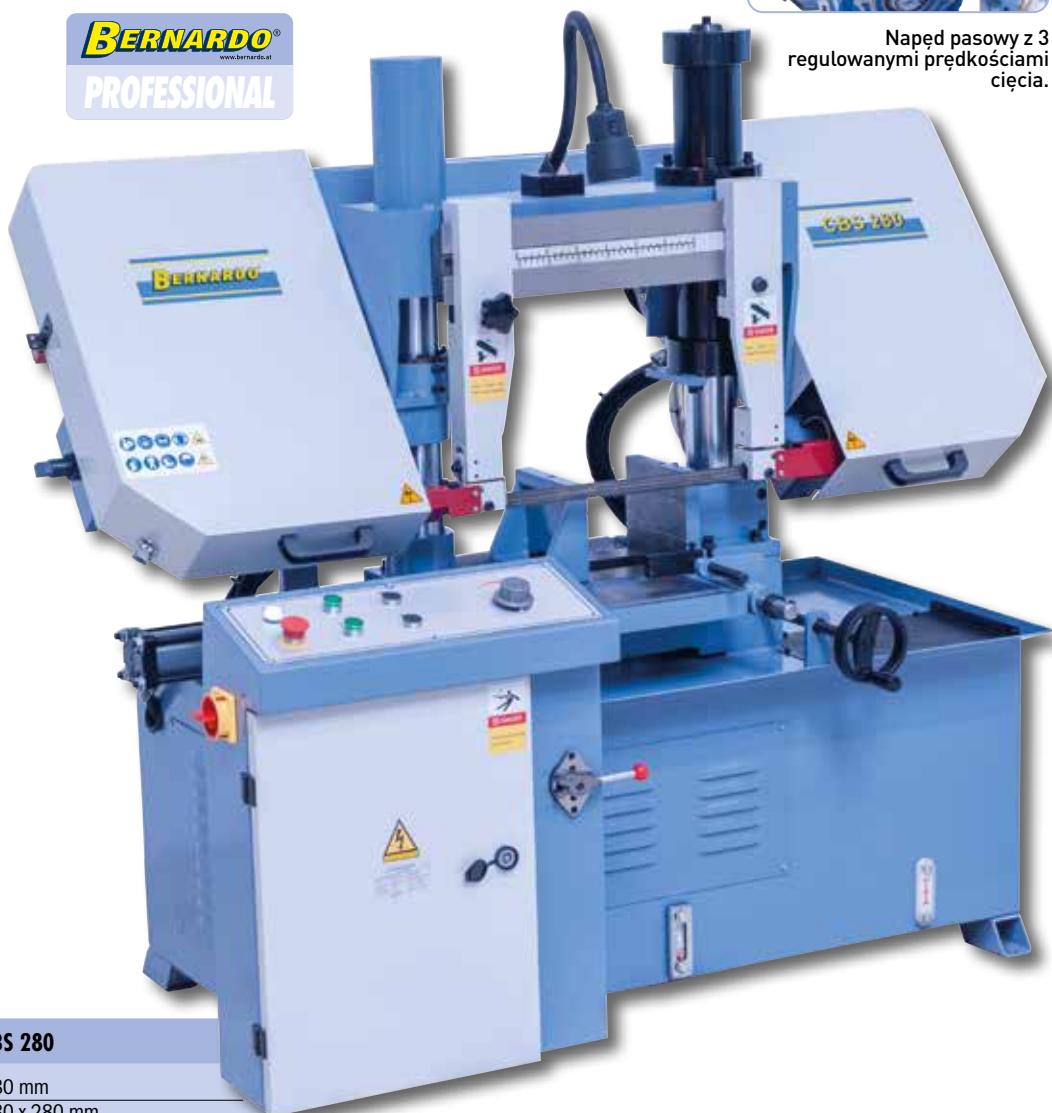
Regulowana prowadnica piły zapobiega jej przesuwaniu się na boki lub wychyleniu z pionu.
