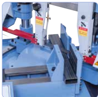
Wychylne ramie pily do cięć pod kątem od 90° do 45°
