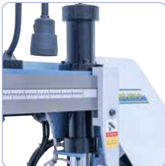
Ramię piły precyzyjnie opuszcza się za pomocą siłownika hydraulicznego.
