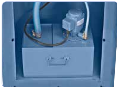
Wydajny układ chłodzenia zajmujący niewiele miejsca w podstawie maszyny
