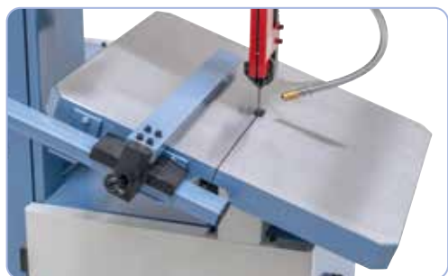
Uchylny stół roboczy wykonany z żeliwa.
