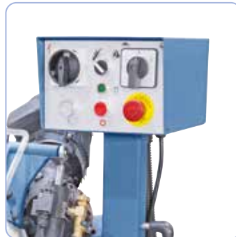
Przejrzyście rozmieszczona skrzynka rozdzielcza po stronie przedniej z regulacją wysokości.
