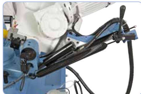
Sprężyny z dźwignią regulacyjną do przestawiania na pracę ręczną.
