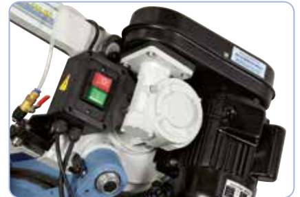
Za pomocą paska wielorowkowego można szybko i łatwo zmienić prędkość cięcia (24 / 41 / 61 / 82 m/min).
