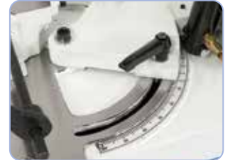
Wychylne ramię piły do cięć pod kątem od -45^\circ do +60^\circ .
