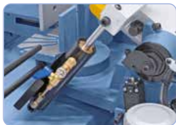
Siłownik hydrauliczny do bezstopniowego opuszczania ramienia pily.
