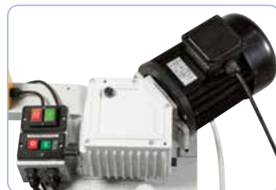
Przekładnia z hartowanymi i szlifowanymi wałkami ślimakowymi, koło ślimaka z brązu
