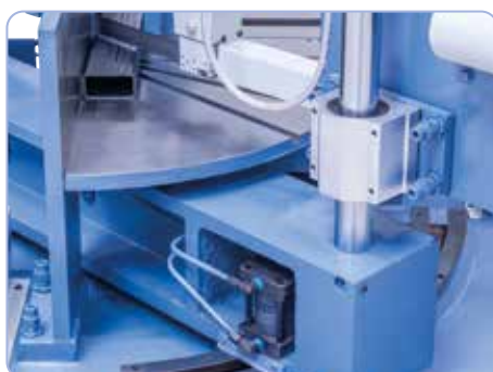
Automatyczna regulacja kąta cięcia za pomocą zacisku hydraulicznego.
