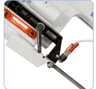
Prowadnica piły na łożyskach kulkowych, z regulacją na szerokość obrabianego przedmiotu i przyłączem płynu chłodzącego.
