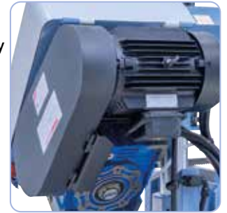
Napęd pasowy z 3 regulowanymi prędkościami cięcia.
