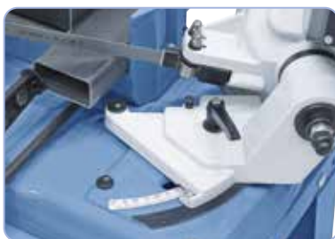
Ramię z blokadą zapewniające lepszą obsługę w zastosowaniach przenośnych
