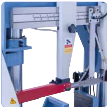
Regulowana prowadnica pily zapobiega jej przesuwaniu się na boki lub wychyleniu z pionu.
