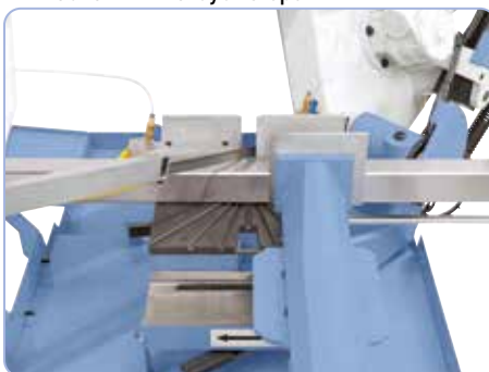
Imadło z szybkim ryglowaniem przesuwne do podwójnych cięć pod skosem.
