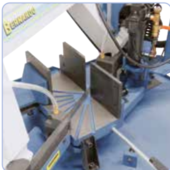
Regulowane ramię do wykonywania cięć skośnych w zakresie od 90° do 60°.
