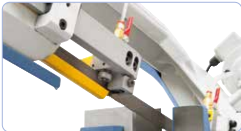
Zespolona prowadnica rolkowa ze stopu twardego zapobiega szybkiemu zużyciu piły taśmowej.
