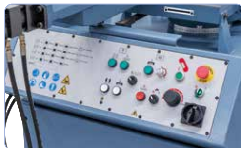
Pokrętło do bezstopniowej regulacji cięcia oraz zawór regulacyjny docisku ramienia piły rozmieszczone w ergonomicznym układzie na pulpicie obsługowym
