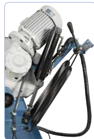
Sprężyny z dźwignią regulacyjną do przestawiania na pracę ręczną.
