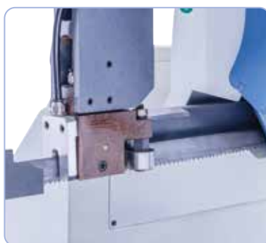
Prowadnica piły oparta na precyzyjnych łożyskach kulkowych i szczotka opiłków zapewnia optymalne rezultaty cięcia.
