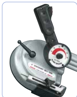
Bezstopniowa regulacja prędkości taśmy zapewniająca optymalne rezultaty pracy
