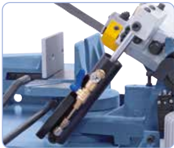
Siłownik hydrauliczny do bezstopniowego opuszczania ramienia piły.
