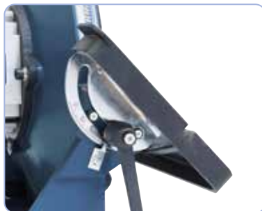
Szlifowany stół z żeliwa szarego wychylny w zakresie od 0° do +45°
