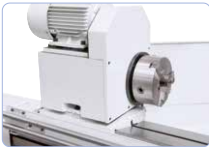
Głowica wrzeciennika jest odchylana +30° do -30°, posiada bezstopniową regulację.
