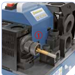
1. Szlifowanie kąta kła \varnothing 2 - 13 mm 2. Szlifowanie kąta kła \varnothing 8 - 32 mm
