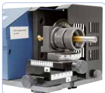
Regulacja kąta szlifowania w zakresie od -30° do +30°
