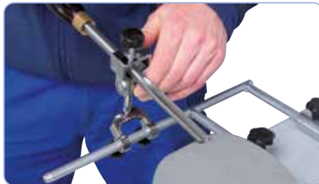
05-2052 Urządzenie do żłobień: maksymalna średnica narzędzia 20 mm
