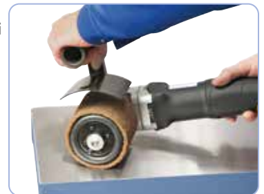
Opcjonalnie wyposażona w pompkę gumowej rolki, która dostosowuje się do szlifowanej powierzchni
