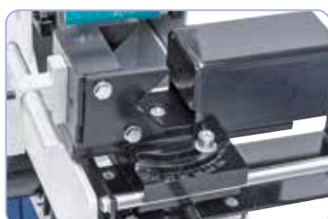
Skala umożliwia łatwy odczyt wymaganego kąta podczas szlifowania.
