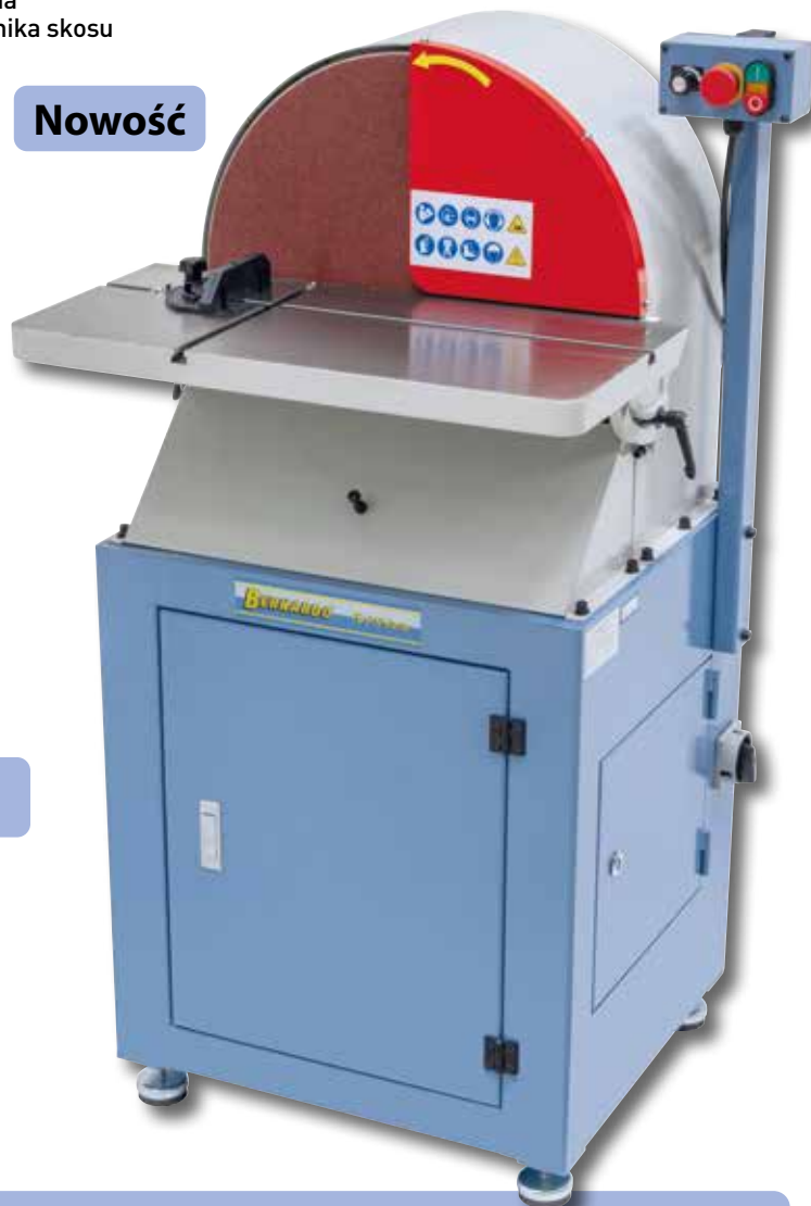
Elektroniczna, bezstopniowa regulacja prędkości obrotowej
