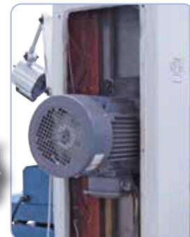
Solidne prowadzenie głowicy szlifierskiej zapewnia precyzyjny dosuw.
