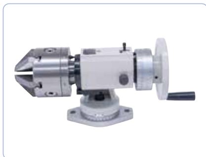
Szlifierka wiertel 50K, Zakres szlifowania: 3 - 32 mm (opcja).
