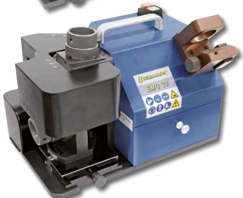
Szlifowanie kąta przyłożenia we frezach o 2 ostrzach
