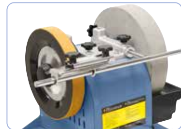
Z tarczą skórzaną do usuwania zadziorów po szlifowaniu.
