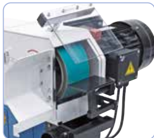
Tyłna część maszyny wyposażona w podporządkowanie materiału oraz dużą ostonę bezpieczeństwa
