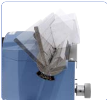
Regulacja kąta fazowania w zakresie od 15° do 45°
