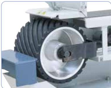
Rolka stykowa 70° - 74° Shore A, optymalna do obróbki zgrubnej
