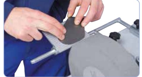
05-2056 Podtrzymka: idealna przy pracach z małymi elementami
