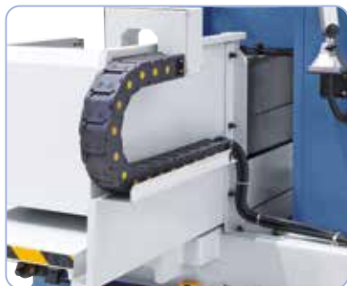
Z kablami zasilającymi w przewodniku tańczuchowym
