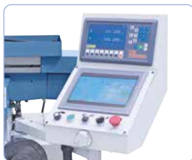
Sterowanie za pomocą ekranu dotykowego i pokrętła elektronicznego.
