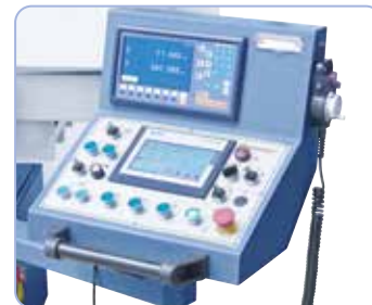
Siemens SMART-panel IE V3 z dotykowym ekranem i elektroniczne koło
