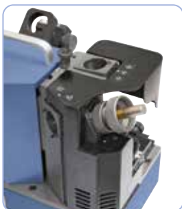
Szlifowanie kąta przyłożenia we frezach o 2 ostrzach
