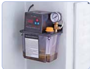
Automatyczne centralne smarowanie wszystkich torów prowadzących i wrzecion.
