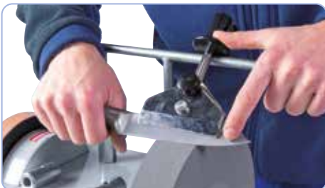
05-2057 Urządzenie do noży: długość ostrza od 100 mm, pasupo także do noży typu ośnik
