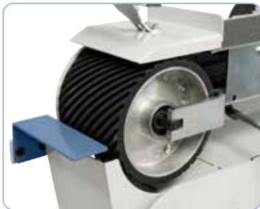
Rolka stykowa 70° - 74° Shore A, optymalna do obróbki zgrubnej
