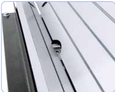
Wysokość fazowania regulowana bezstopniowo w zakresie 0 - 3 mm
