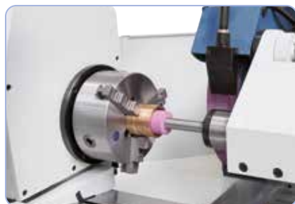
Kompletna z demontowalnym wewnętrznym urządzeniem szlifującym.
