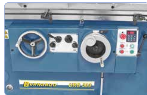
Przejrzyście rozmieszczone najważniejsze elementy obsługowe z przodu maszyny
