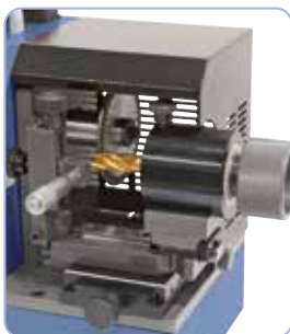
szlifowania zewnętrznej krawędzi tnącej spirali
