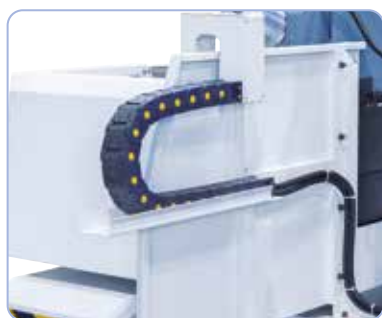
Z kablami zasilającymi w przewodniku łańcuchowym
