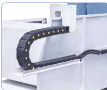
Z kablami zasilającymi w przewodniku tańcuchowym
