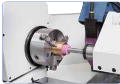
Kompletna z demontowalnym wewnętrznym urządzeniem szlifującym.
