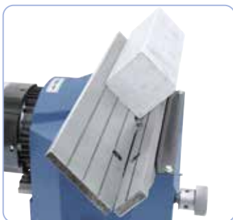
Duża prowadnica umożliwiająca swobodne zakładanie obrabianego przedmiotu
