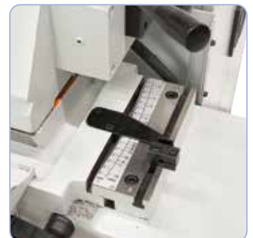
Do szlifowania stożków między kłtami stół można odchylić w zakresie od +3° do -7°.
