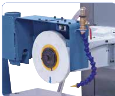
Bezwibracyjna praca i wysoka precyzja wrzeciennika ściernicy dzięki zamocowanym bez luzów specjalistycznym łożyskom.
