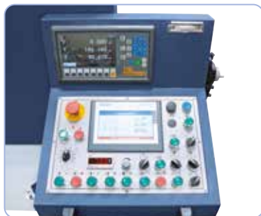
Łącznie Siemens SMART-panel IE V3 z dotykowym ekranem i elektroniczne koto
