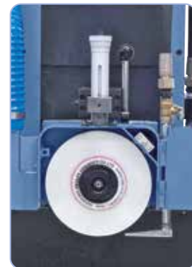
Bezwibracyjna praca i wysoka precyzja wrzeciennika ściernicy dzięki zamocowanym bez luzów specjalistycznym tożyskom.
