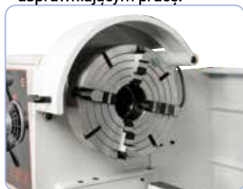
Uchwyt tokarski 400 mm (opcja) idealny do mocowania niesymetrycznych przedmiotów obrabianych.
