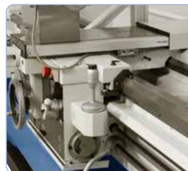
Z szybkim biegiem w ruchu wzdłużnym i poprzecznym sań.
