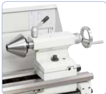
Konik z zaciskiem jednodźwigniowym, regulowany do toczenia stożków, może być również dostarczany z kłmem grzybkowym
