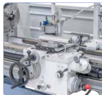
42 dowolnie wybieranych posuwów do ruchu wzdłużnego i poprzecznego sań, wzgl. sań poprzecznych
