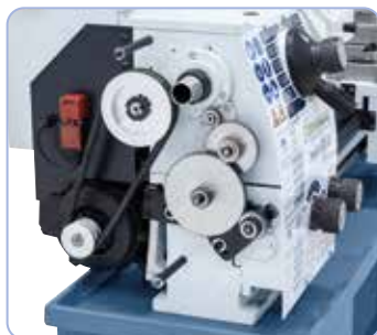
W wyposażeniu standardowym z kołami zamiennymi do gwintowania.
