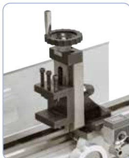
Możliwość dozbrojenia pionowego suportu frezowania w celu umożliwienia dodatkowych rodzajów obróbki.
