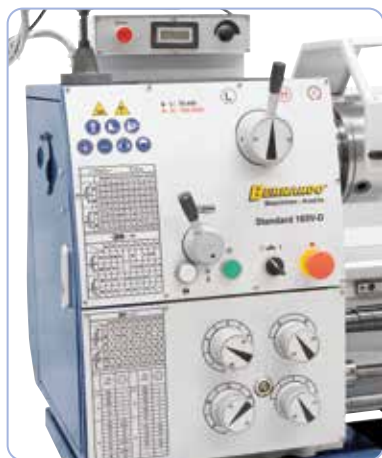
Łatwa obsługa, wszystkie elementy przełączające i obsługowe przejrzyste rozmieszczone w głowicy przekładni
