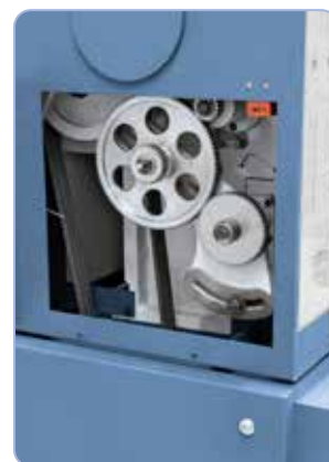
W zakresie dostawy kompletny zestaw wymiennych kół do gwintowania.
