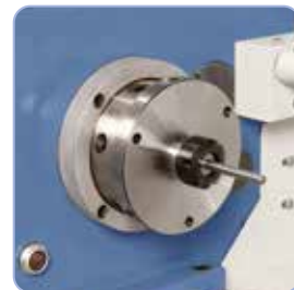
Tuleja zaciskowa ER 25 zapewnia idealną współosiowość podczas obróbki elementów, zakres zacisku 1 - 16 mm
