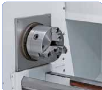
W wyposażeniu standardowym z uchwytem 3-szczękowym 160 mm.
