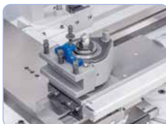
W celu usprawnienia pracy maszyny można wyposażyć w szybkowymienne uchwyty.
