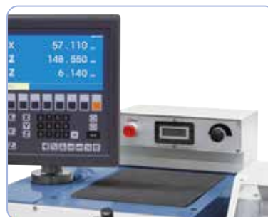
Elektroniczna, bezstopniowa regulacja prędkości obrotowej, czytelne wskazania na cyfrowym wyświetlaczu.
