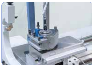
Maszyna w wyposażeniu standardowym posiada szybkowmienny uchwyt.
