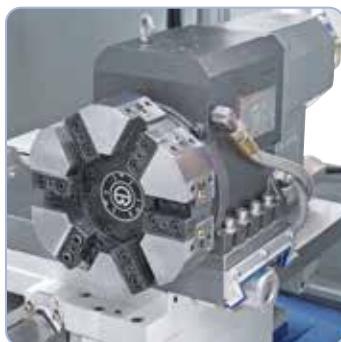
Mocny rewolwer narzędziowy z 6 stanowiskami.
