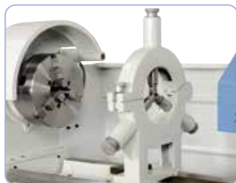
Stała podtrzymka z prowadnicą do stabilizowania długich przedmiotów obrabianych
