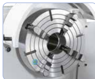
Uchwyt tokarski 250 mm (opcja) idealny do mocowania niesymetrycznych przedmiotów obrabianych.
