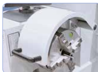
Centrycznie skrawający uchwyt 4-szczękowy 200 mm, optymalny do kwadratowych przedmiotów obrabianych (opcja).
