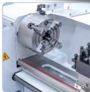
Uchwyt tokarski 100 mm (opcja) do mocowania przedmiotów obrabianych o nieregularnych kształtach.
