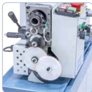
W zakresie dostawy wymienne koła do gwintowania.
