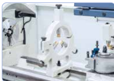
Staća podtrzymka z prowadnicą do stabilizowania długich przedmiotów obrabianych
