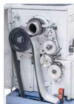
Hartowane wrzeciono główne z precyzyjnymi łożyskami poprzecznymi stożkowymi zapewniające wysoką współosiowość biegu, optymalne przeniesienie napędu za pośrednictwem pasków wielorolkowych Optibelt
