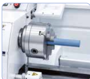
W wyposażeniu standardowym z otworem wrzeciona 38 mm do obróbki walców o dużych średnicach
