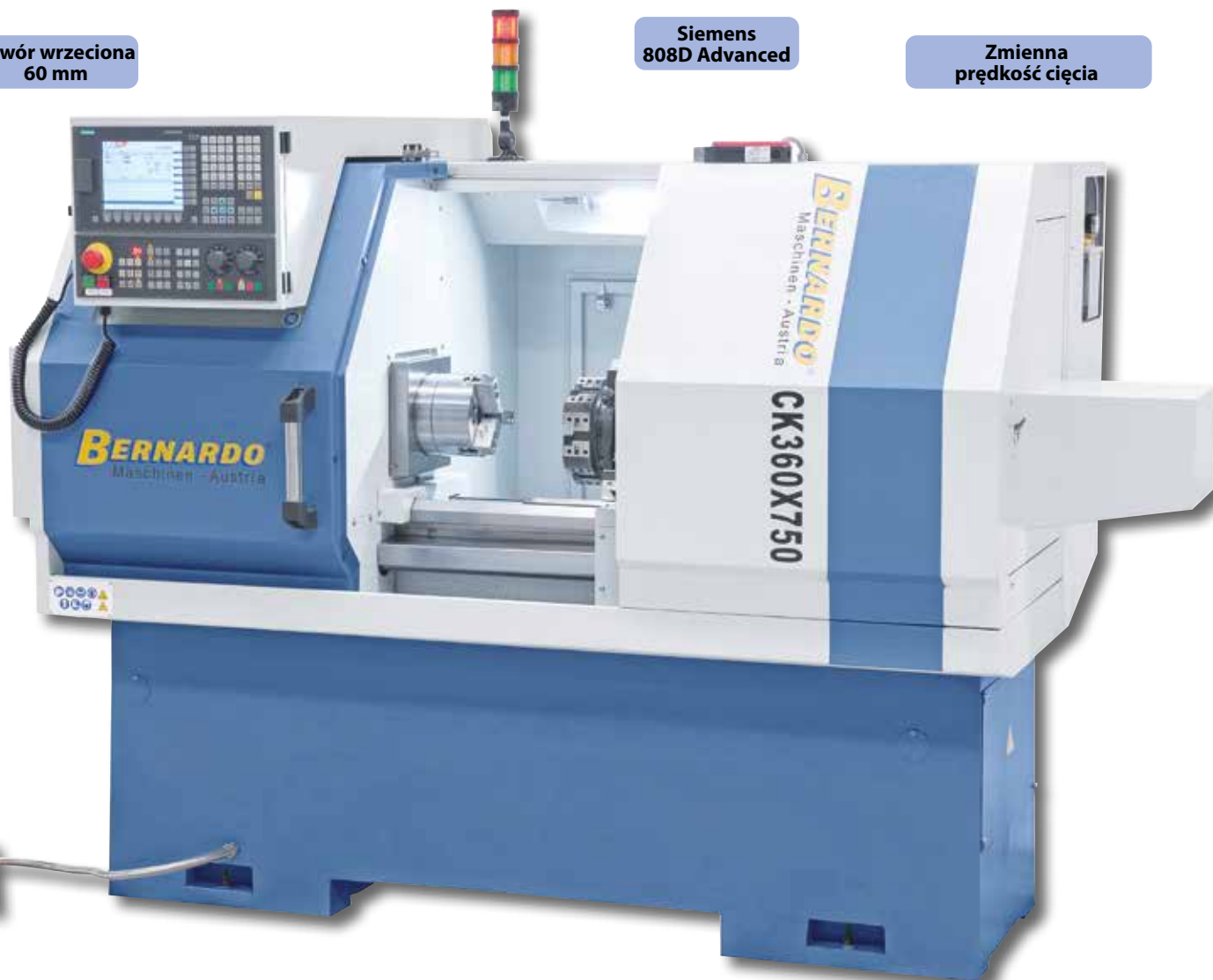
Mocny rewolwer narzędziowy z 6 stanowiskami.
