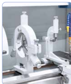
W wyposażeniu standardowym ze stałą i ruchomą podtrzymałą do unieruchamiania długich przedmiotów obrabianych.
