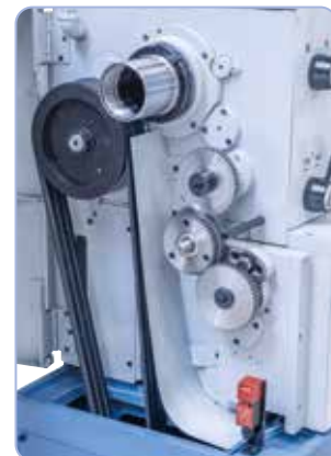
Hartowane wrzeciono główne z precyzyjnymi łożyskami poprzecznymi stożkowymi zapewniające wysoką współosiowość biegu, optymalne przeniesienie napędu za pośrednictwem pasków wielorolkowych Optibelt
