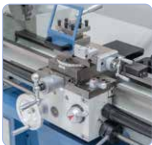
Swobodnie poruszające się sanie narzędziowe oraz imak czteronożowy, koła ręczne z precyzyjną skalą
