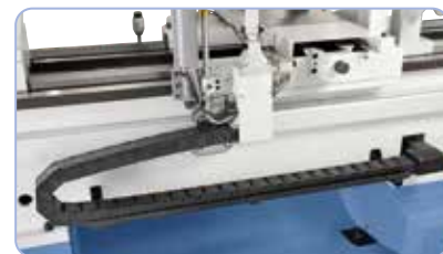
Z kablami zasilającymi w przewodniku tańcuchowym
