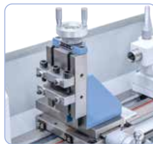
Możliwość dozbrojenia pionowego suportu frezowania w celu umożliwienia dodatkowych rodzajów obróbki.
