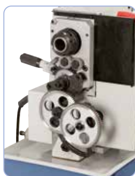
Seryjnie wyposażona w metryczne koła zmianowe do gwintowania
