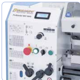
Elektroniczna, bezstopniowa regulacja prędkości obrotowej, czytelne wskazania na cyfrowym wyświetlaczu.
