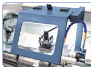
Zintegrowana lampa LED w osłonie ochronnej dla optymalnego oświetlenia podczas pracy.
