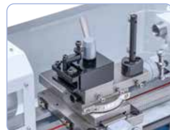
Maszyna w wyposażeniu standardowym posiada szybkowymienny uchwyt.
