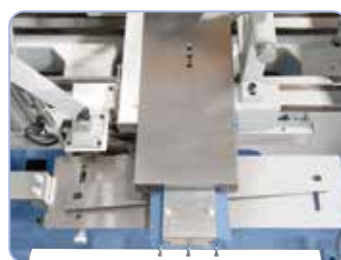
Opcjonalna przystawka do toczenia stożków, długość toczenia 455 mm, regulacja kąta ± 8°
