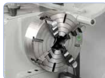
Uchwyt tokarski 320 mm (opcja) idealny do mocowania niesymetrycznych przedmiotów obrabianych.
