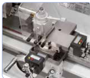
Maszyna w wyposażeniu standardowym posiada szybkowymienny uchwyt.
