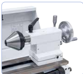
Konik z zaciskiem jednodźwigniowym, regulowany do toczenia stożków, może być również dostarczany z kłem grzybkowym
