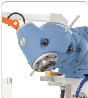
Uniwersalna głowica frezu z 2 osiami obrotowymi, ustawiana pod każdym kątem.
