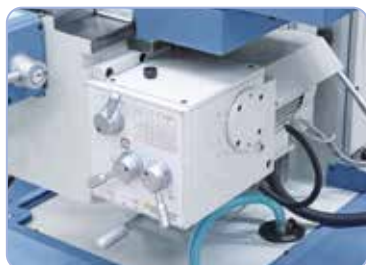
Znacznie skrócenie czasów obróbki dzięki dostępnemu w wyposażeniu standardowemu posuwowi stołu z funkcją szybkiego biegu
