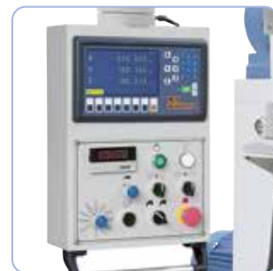
Konwerter częstotliwości do regulacji prędkości obrotowej wrzeciona pionowego.
