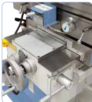
Prowadnica prostokątna w osi y i z dzięki dużym wymiarom zapewnia dobrą stabilność.
