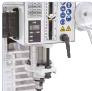
W wyposażeniu duży kiel o skoku 125 mm, w wyposażeniu standardowym z cyfrowym wskaźnikiem skoku
