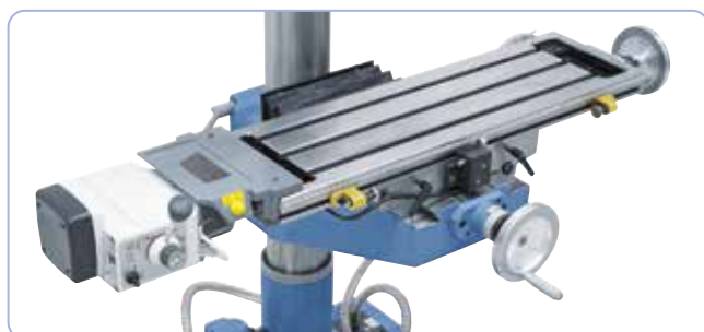
Stół krzyżowy o dużych wymiarach z rowkami teowymi i kanałem chłodziwa. Ilustracja z opcjonalnym posuwem stołu AL 450 D
