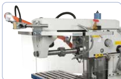
Frezowanie poziome z podtrzymałą
