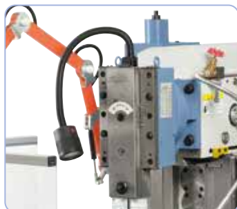
Głowica do dłutowania (opcjonalna) z regulowanym skokiem może być ustawiona w lewo lub w prawo.
