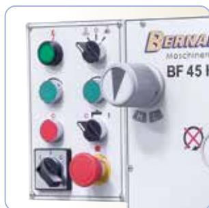
Przejrzyście rozmieszczone elementy przelączające i obsługowe w głowicy przekładni
