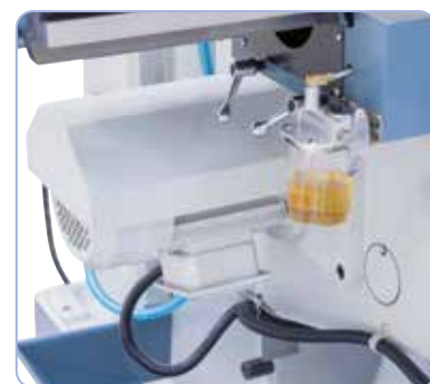
Z silnikiem pozycjonującym stołu frezowego w osi z
