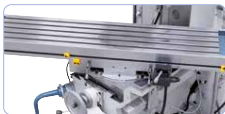
Stół do frezowania odchylany w zakresie od -45° do +45°
