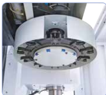
16-miejscowa zmieniarka narzędzi zapewniająca krótkie czasy przezbrajania
