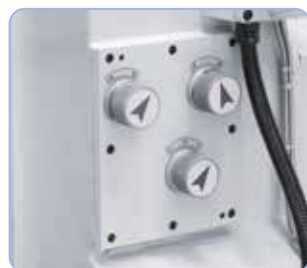
W wyposażeniu standardowym z prostym w obsłudze układem przelazania przekładni trzpienia poziomego.
