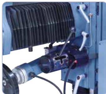
Dźwignia selektora do posuwu (rys 05 x i z), regulacja prędkości posuwu za pomocą potencjometru z kontrolą na panelu sterowania
