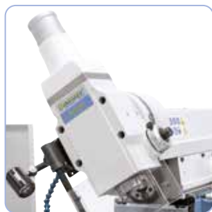
Wychylna pionowa głowica frezująca z ręcznie przestawianym kłem.
