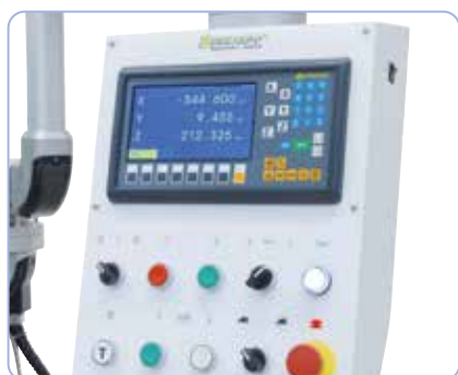
Cyfrowy wyświetlacz 3 osi w celu skrócenia procesu produkcji.
