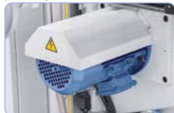
Silnik pozycjonujący regulacji wysokości (oś z) stołu.
