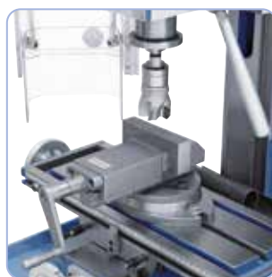
Frezowanie przy pomocy frezu czołowego i kąтового (nr kat. 42-1057)
