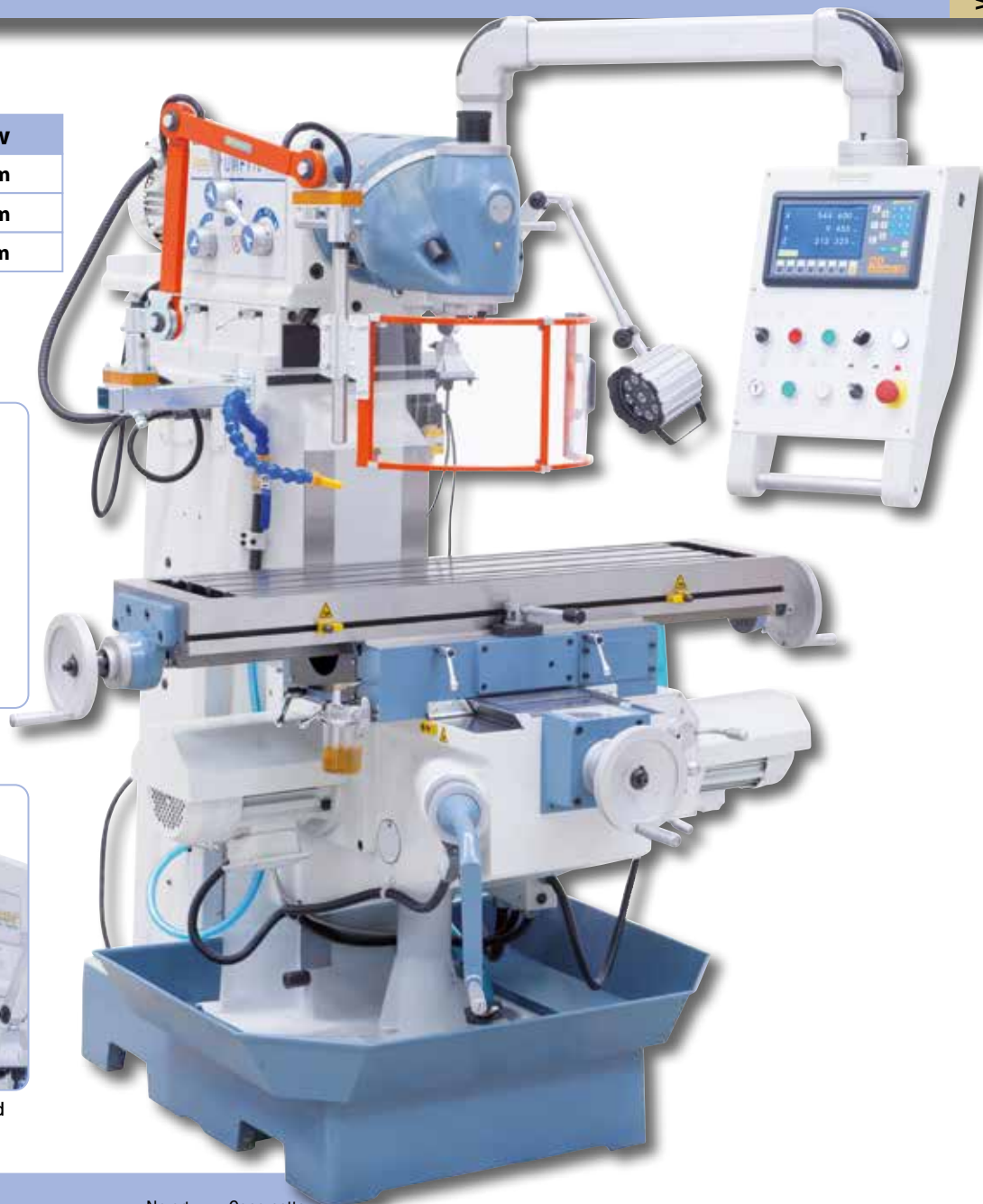
Uniwersalna głowica frezu, ustawiana pod różnymi pozycjami kątowymi
