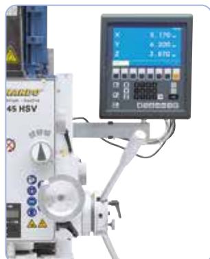
Cyfrowy wyświetlacz LCD ES-12 V z różnorodnymi funkcjami, takimi jak np.: obróbka otworów kołowych, funkcja frezowania kieszeni, ...
