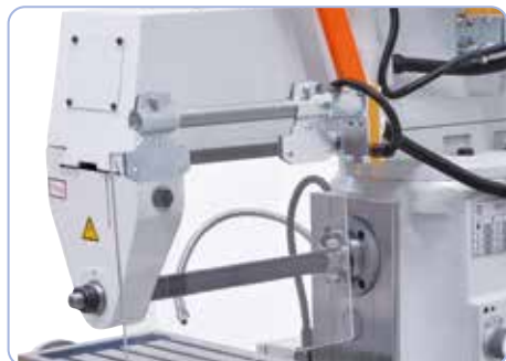
W wyposażeniu standardowym z podtrzymką i długim trzpieniem frezowym do frezowania poziomego
