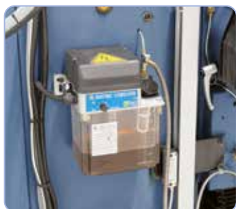
Elektryczne centralne smarowanie
