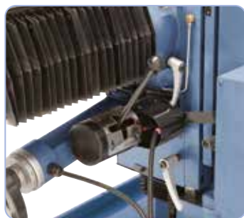
Dźwignia selektora do posuwu (rys Oś x i z), regulacja prędkości posuwu za pomocą potencjometru z kontrolą na panelu sterowania
